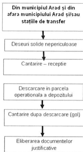
Figură 1 Schema de funcționare a (depozitului)
