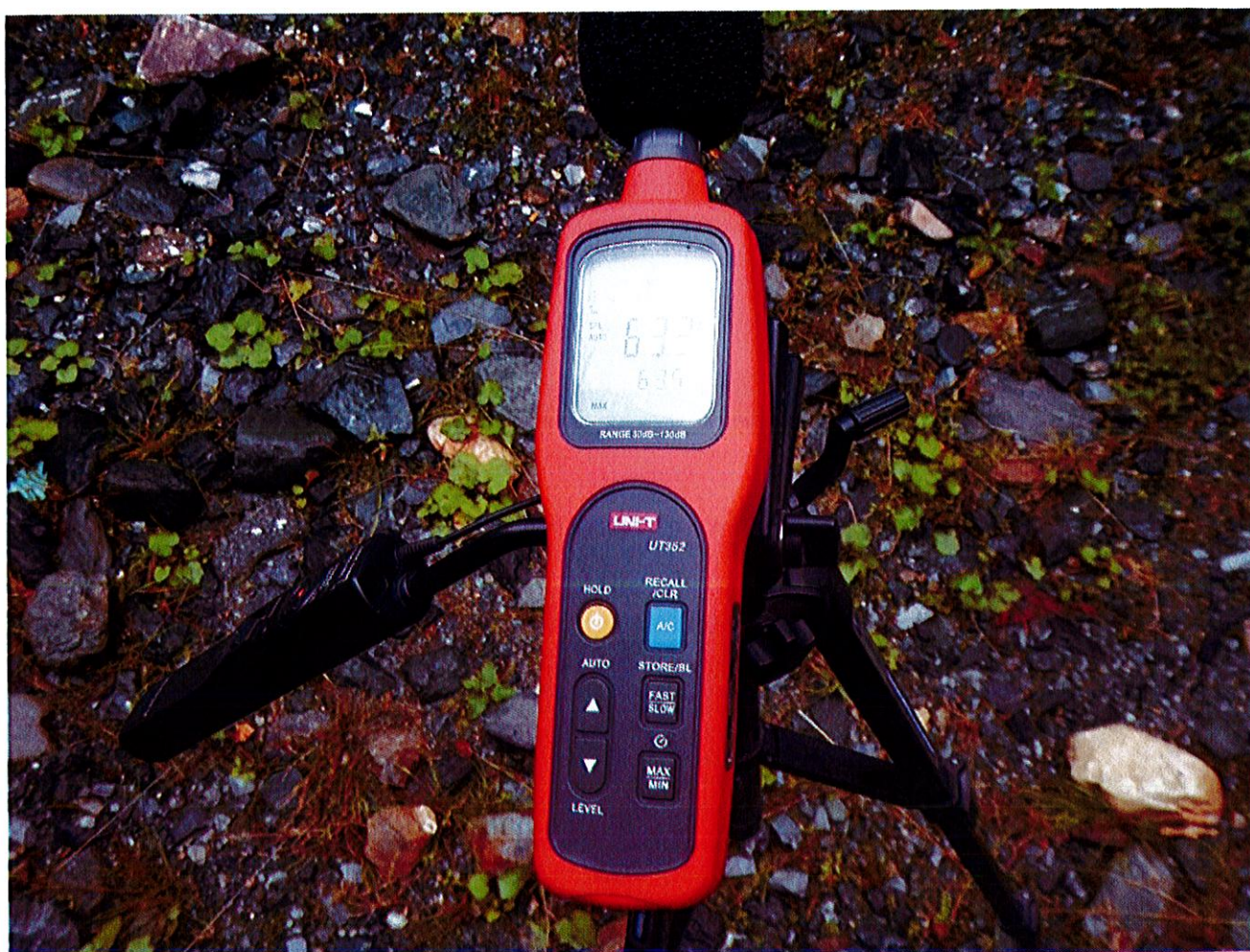
Figura 40. Sonometrul UNI-T model UT350 utilizat pentru măsurarea nivelului de zgomot în zona Păuliș Vie
