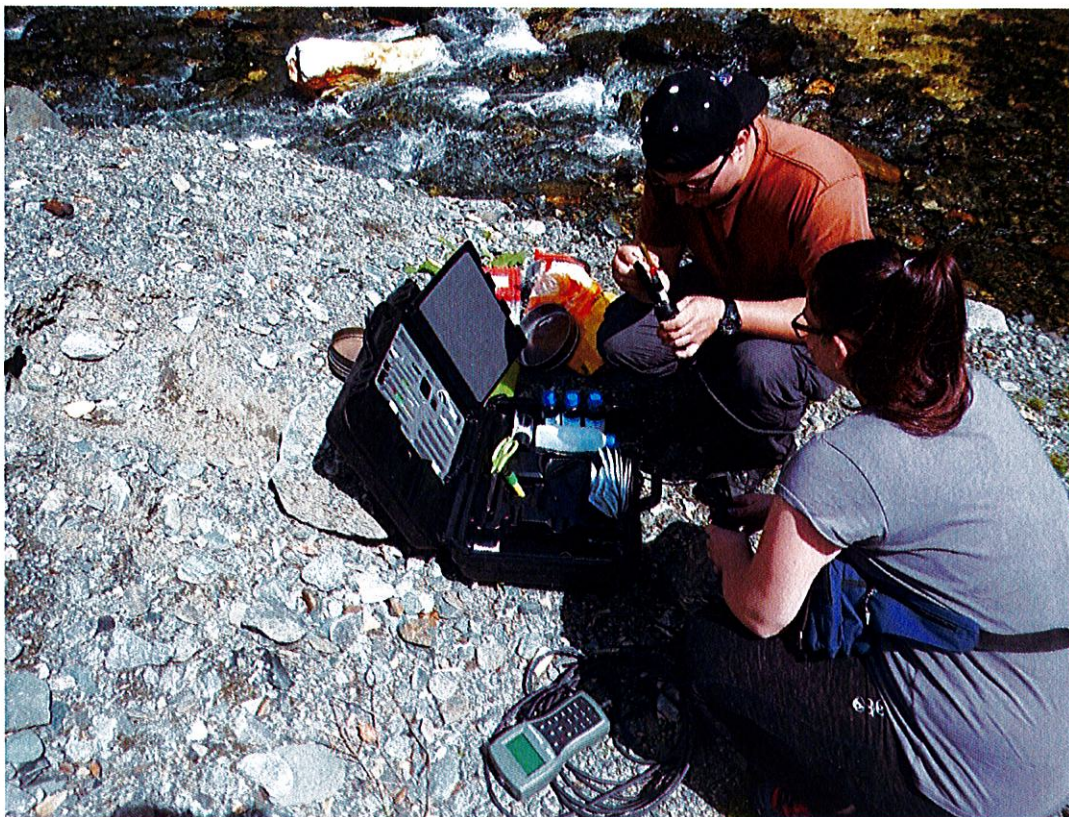
Figura 36. Măsurarea turbidității apei cu ajutorul analizorului portabil multiparametru Hanna 9289
