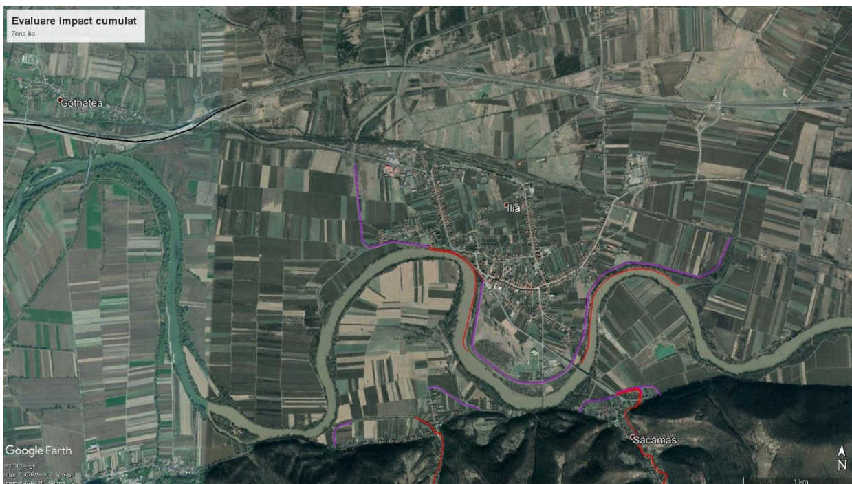
Figură 20. Evaluarea impactului cumulat în zona localității Iliia; sunt prezentate pe planșă supraînălțările de dig (mov), consolidările de mal (roșu – parapet sau prism de anrocamente) și autostrada în construcție (negru)
