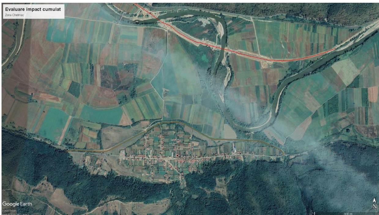
Figură 18. Evaluarea impactului cumulat în zona localității Chelmac; sunt prezentate pe planșă digul propus a se supraînălța (maro) și calea ferată în construcție (roșu)
