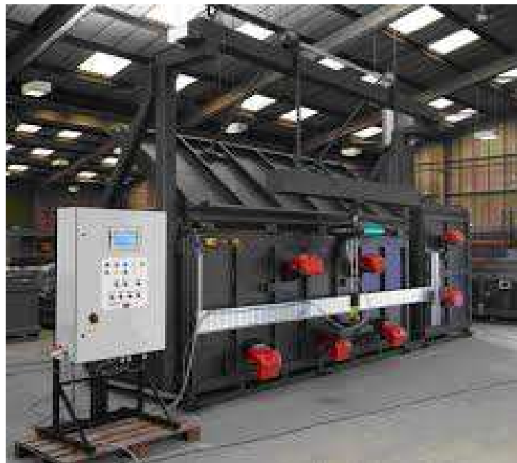
Figură 2: vedere incinerator din spate (zona arzătoarelor)
