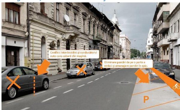
Figura 127 - Ilustrare mod de ajustare a benzilor velo
